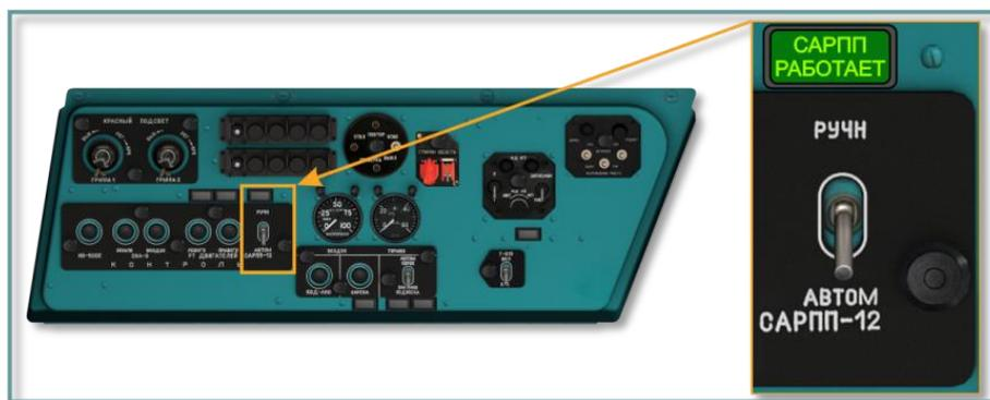
**Рис. 7.40. Выключатель и табло САРПП**
