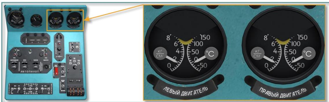
Рис. 5.22. Двухстрелочный моторный индикатор ЭМИ-ЗРИ
