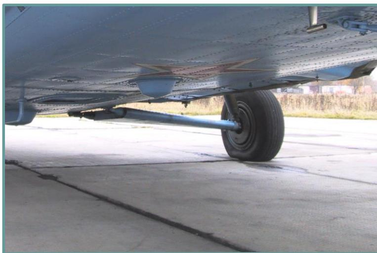
Рис. 6.15. Антенный блок АРК-УД
