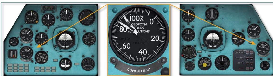
Рис. 5.20. Двухстрелочный тахометр ИТЭ-2Т
