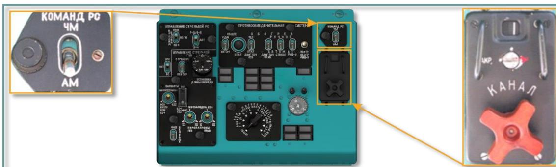
**Рис. 6.2. Переключатель "КОМАНД. РС АМ-ЧМ" для выбора вида модуляции несущей частоты звуковых колебаний; запоминающее устройство (ЗУ) с переключателем на 20 каналов**
