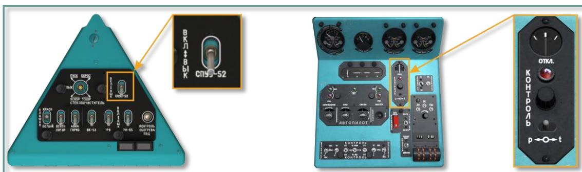
**Рис. 5.18. Органы управления и контроля СПУУ-52**
