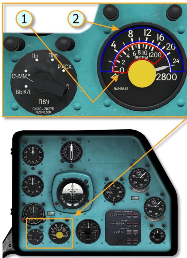
**Рис. 7.8. Топливомер**
