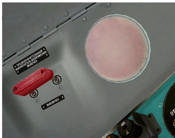
**Рис. 11.4. Расположение предохранительных выключателей вооружения вместе с плафоном, сигнализирующим об их включении (красного цвета).**
