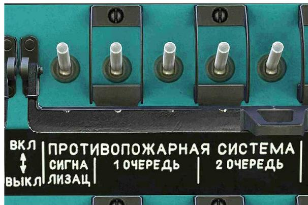
Рис. 7.25. АЗС противопожарной системы
