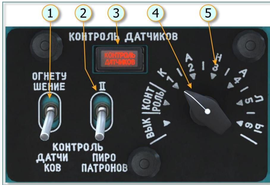
**Рис. 7.29. Щиток КОНТРОЛЬ ДАТЧИКОВ на средней панели электропульты**
