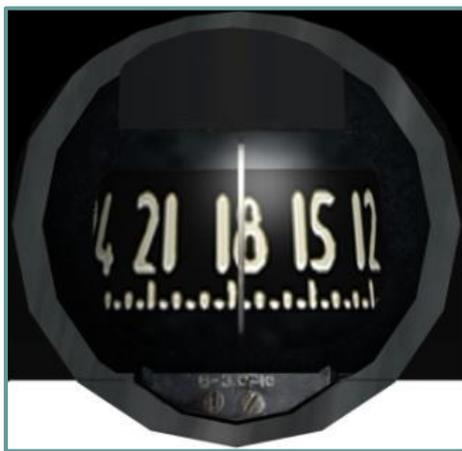
Рис. 5.51. Магнитный авиационный компас КИ-13К
