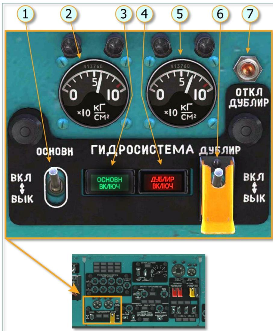
**Рис. 7.11. Панель управления гидросистемы**
