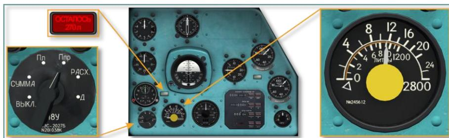
Рис. 5.32. Топливомер СКЭС-2027В
