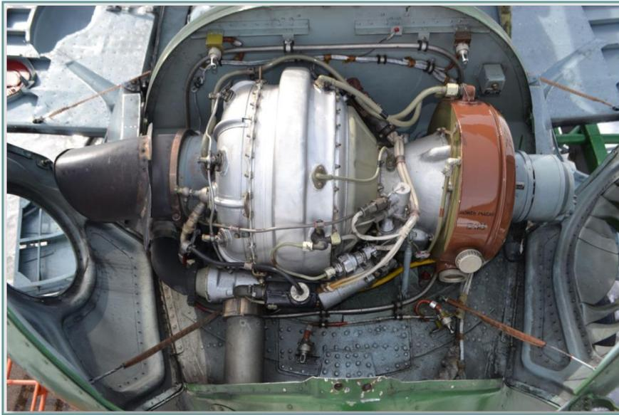
**Рис. 4.4. Газотурбинный двигатель АИ-9В**
