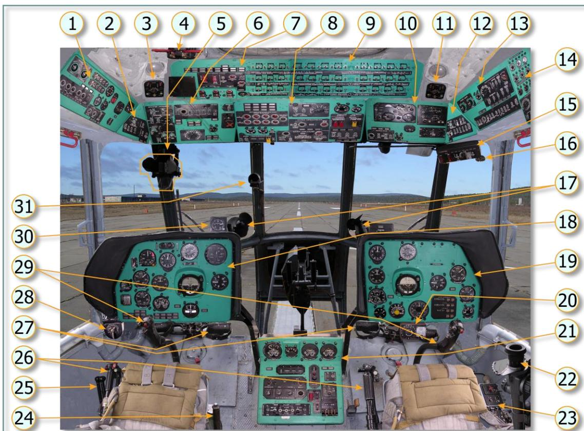
Рис. 5.1. Расположение панелей, органов управления и оборудования
