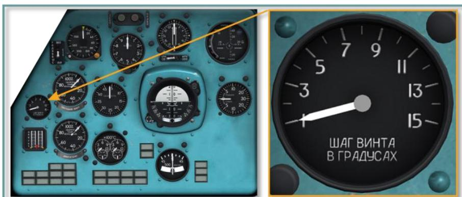
Рис. 5.31. Указатель шага винта УП-21-15
