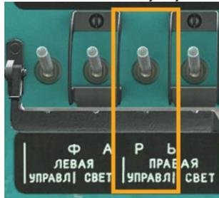
УПРАВЛЕНИЕ . Включается выключателем ФАРЫ – РУЛЁЖНАЯ, установленным рядом с переключателем левой фары ФПП-7, ([Рис. 7.35](#), 1) **[RCtrl + L]**.
