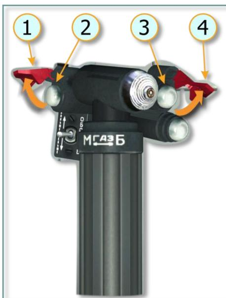
**Рис. 7.43. Управление сбросом груза с РОШ**
