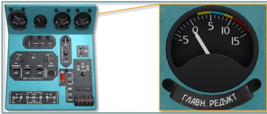
Рис. 5.26. Термометр ТУЭ-48
