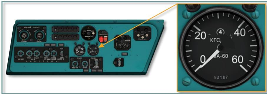
Рис. 5.35. Манометр МА-6К
