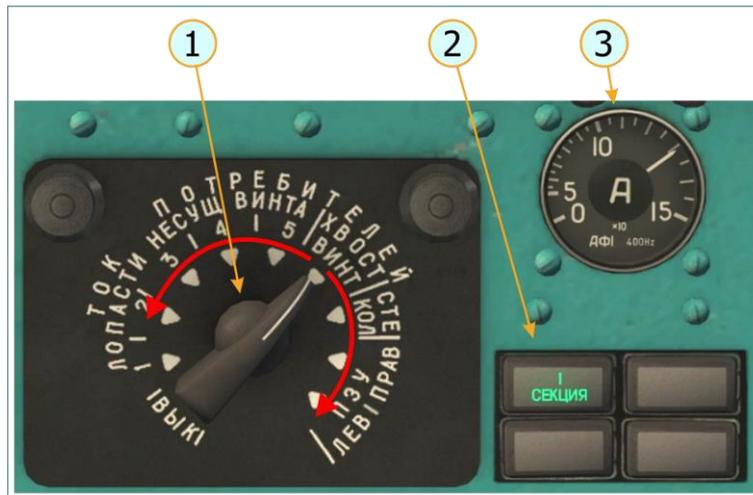
**Рис. 7.18. Контроль работы нагревательных элементов электрической части ПОС вертолета**
