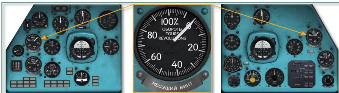
Рис. 5.21. Тахометр ИТЭ-1Т
