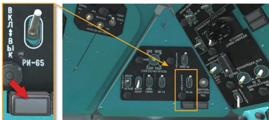
Рис. 6.11. Выключатель РИ-65Б и световое табло ВКЛЮЧИ РИ-65
