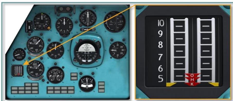
Рис. 5.25. Измеритель режимов работы двигателей ИР-117
