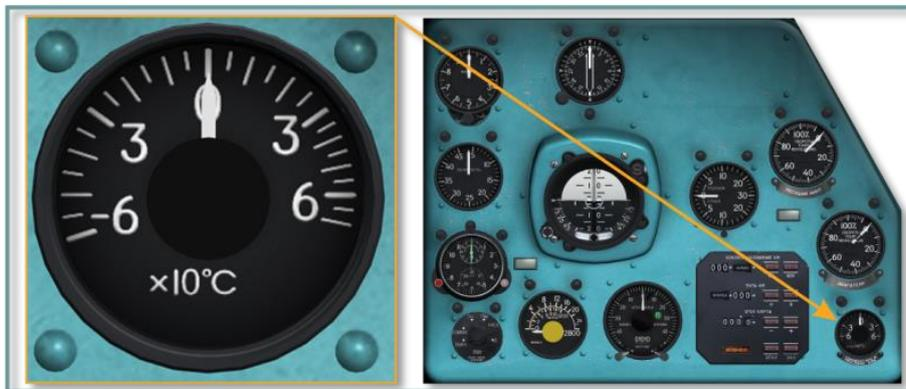
Рис. 5.27. Термометр ТВ-19
