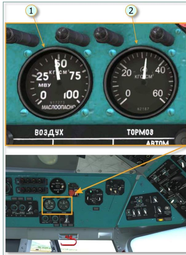
**Рис. 7.23. Манометры пневмосистемы**
