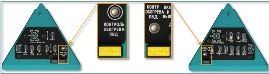
Рис. 5.39. Табло и кнопка контроля обогрева ПВД
