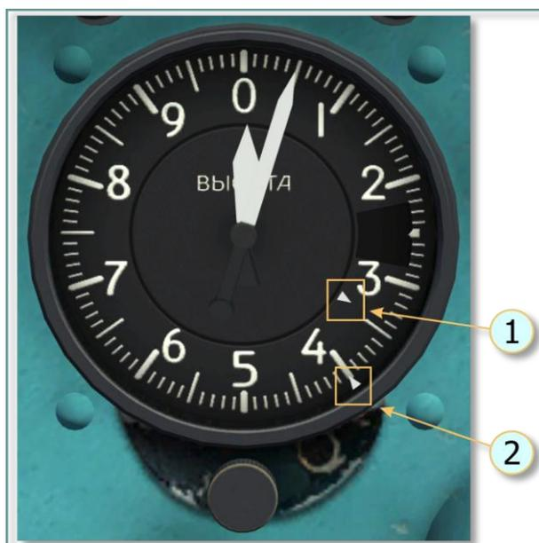
Рис. 5.43. Установка высоты площадки треугольными индексами
