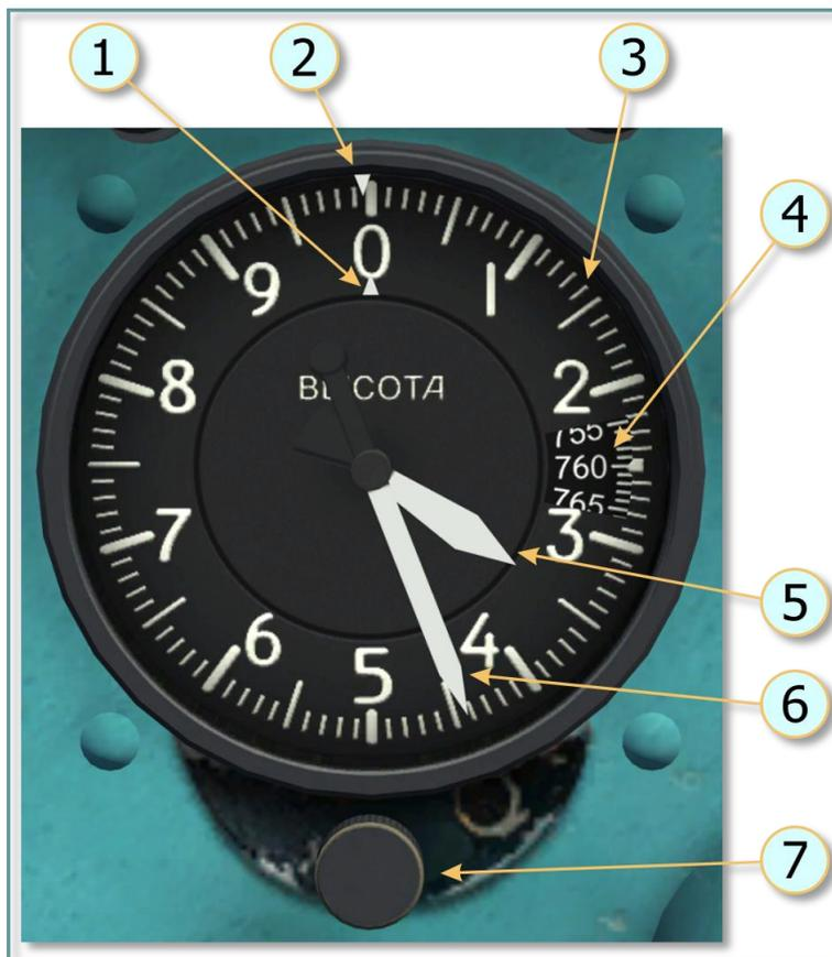
**Рис. 5.42. Элементы лицевой панели высотомера**
