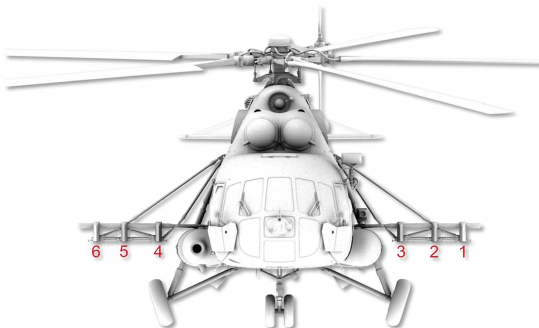
Рис. 11.2. Нумерация балочных держателей БДЗ-57КрВ на фермах.
