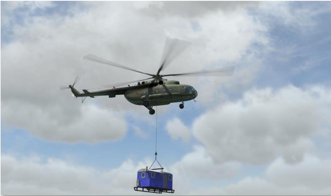
**Рис. 7.41. Вертолет с грузом на внешней подвеске**
