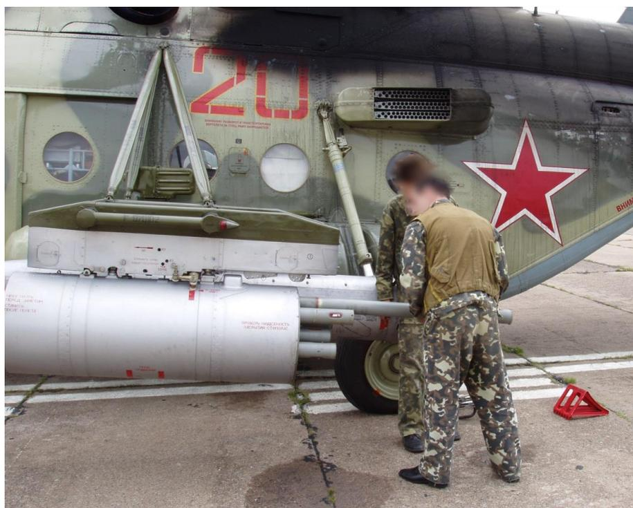
**Рис.11.13. Зарядка блоков Б8В20-А на вертолет Ми-8МТВ5**
