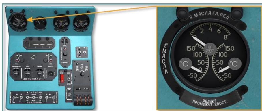
Рис. 5.23. Трехстрелочный моторный индикатор ЭМИ-ЗРВИ
