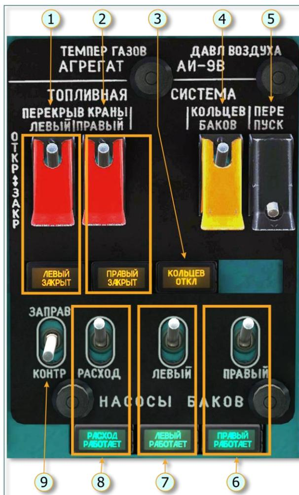
**Рис. 7.7. Панель управления топливной системой на средней панели электропульты**
