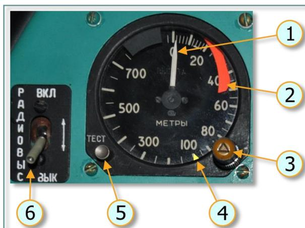
**Рис. 6.22. Индикатор высотомера**
