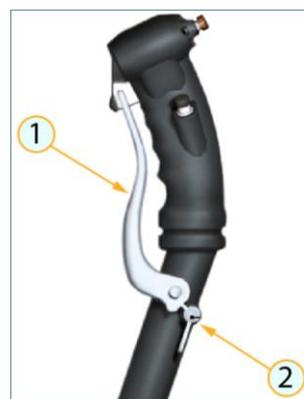
**Рис. 7.24. Рычаг тормозов колес на РППУ левого летчика**
