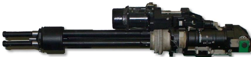
**Рис. 11.23. 4-х ствольный пулемет ГШГ-7,62**
