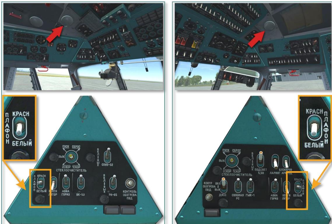
Рис. 7.37. Плафоны дежурного освещения
