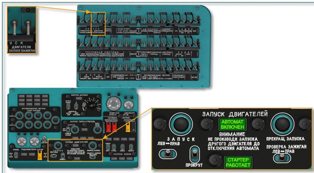
**Рис. 4.7. Панель запуска двигателей**
