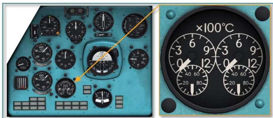
Рис. 5.24. Указатель температуры выходящих газов двигателей 2УТ-6К
