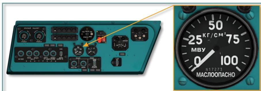
**Рис. 5.34. Манометр МВУ-100К**
