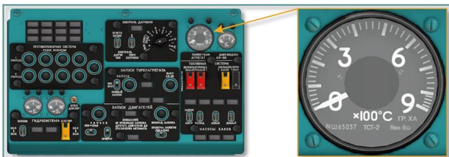
Рис. 5.28. Индикатор температуры ТСТ-2
