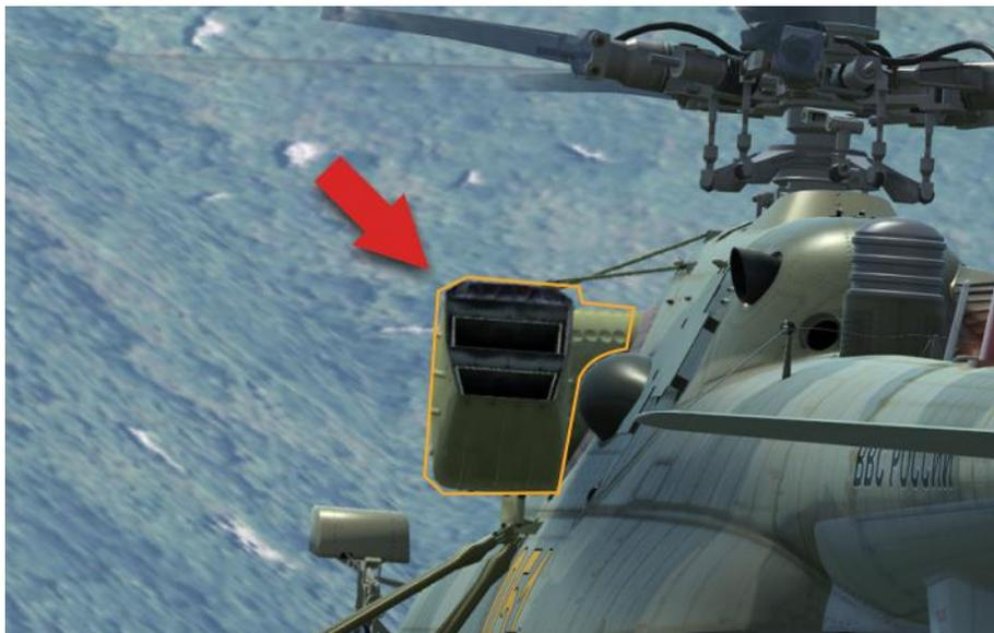
**Рис. 7.49. Экранно-выхлопное устройство Ми-8МТВ2**
