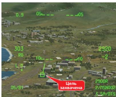
Квадрат перемещается кноппелем SLEW CONTROL (кнопки «», «.»), «/» и «;»). Для захвата цели нажмите и удерживайте кноппель TMS вверх (LCtrl + вверх). После захвата на ИЛС над целью появится линия, направленная вверх:
