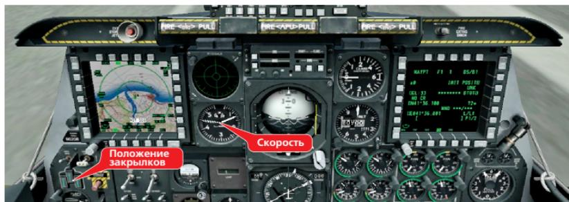
Как только самолет начнет устойчиво набирать высоту, уберите шасси нажатием на кнопку G. Уменьшите угол наклона самолета, разгонитесь до 150 узлов. Уберите закрылки, нажав LCtrl+F. Продолжайте набор высоты на скорости 175 узлов.
