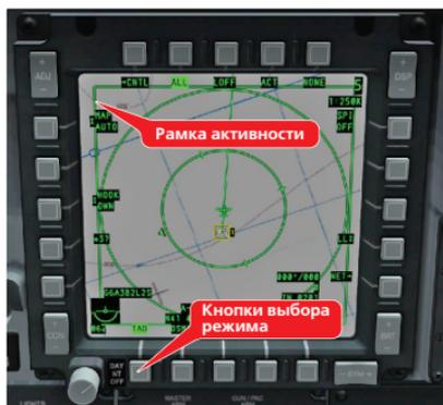
Самолет А-10С разработан по идеологии «HOTAS». Это означает, что большую часть действий можно выполнять, не снимая рук с ручки управления самолетом и ручек управления двигателями. Так как количество кнопок ограничено, кнопки на ручках работают с «активным» дисплеем, обозначаемым SOI. Активный дисплей выделяется рамкой:
