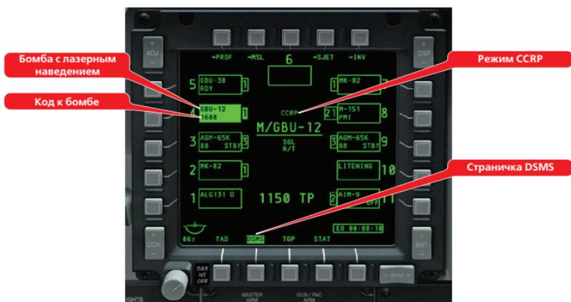
Подготовьте самолет к боевому применению. Выберите бомбу с лазерным наведением (GBU-12) на страничке DSMS, нажав боковую кнопку напротив нее. При помощи кнопки Master Mode Control Button (M) установите режим CCRP.
