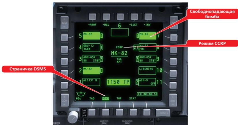
На экране появится линия прицеливания, прицельное кольцо снизу и точка прицеливания сверху. Удерживайте самолет таким образом, чтобы линия сброса совпала с прицельной линией.
