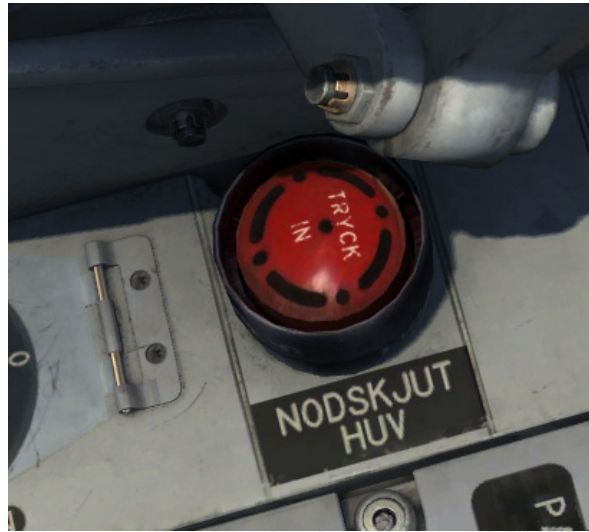
Figure 169. Canopy Jettison button (NÖDSKJUT HUV)
