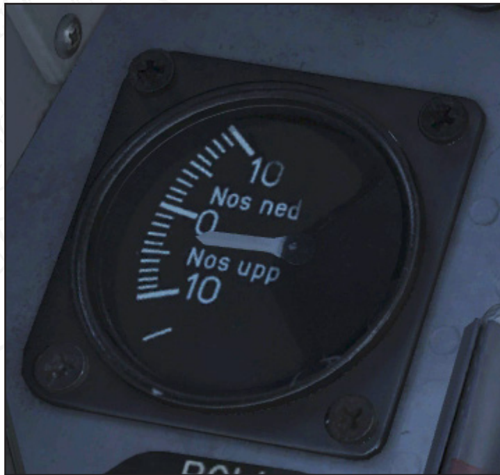
Figure 53. Pitch trim. 3^\circ nose up trim.
